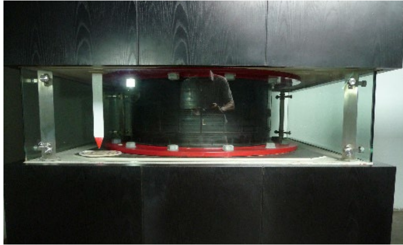
Imaj 4. Yo mete yon sipò kawotchou won ki gen plizyè plak asye mens ant baz chak kolòn ak fondasyon an pou izole bilding nan kont sekous orizontal tranblemann tè.
