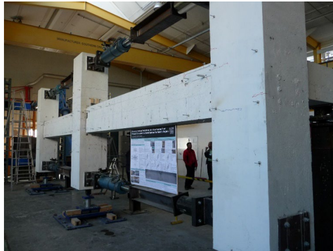
Imaj 1. Kolòn ak travès an beton ame nan vrè gwosè yo ki ap teste nan yon laboratwa.
