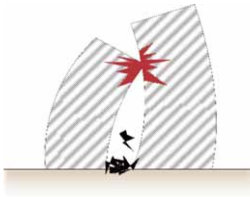
图 15-1 两个建筑之间的间距不足，在地震时相互撞击
