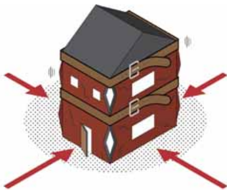
图 8-1 位于每层和屋顶的圈梁像坚固的腰带一样把地震中受损的建筑构件连接在一起
