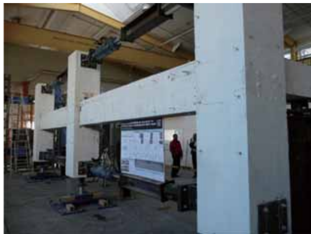
图 16-1 正在实验室测试的足尺钢筋混凝土梁柱
