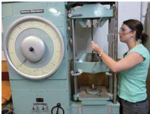
图 20-1 正在测试钢筋以检查其是否达到标准
