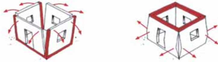
图 8-3 无圈梁的建筑墙柱发生倒塌，屋顶的圈梁可以将建筑连接成整体 引自《Guidebook for building earthquake-resistant houses in confined masonry》（砌体结构抗震房屋建造指南）（Swiss Agency for Development and Cooperation SDC（世界住房百科全书），2018）
