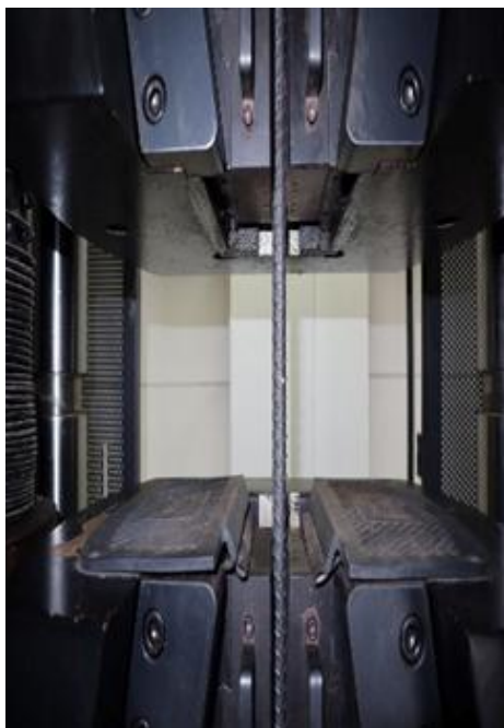
Gambar 1. Pengujian tarik tulangan baja untuk memeriksa kualitasnya
