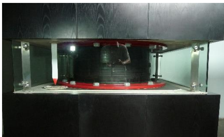
Gambar 4. Bantalan berbentuk silinder yang terbuat dari lapisan karet dan pelat baja tipis diletakkan di antara bagian bawah setiap kolom dengan fondasinya untuk mengisolasi bangunan dari gerakan gempa horizontal.
