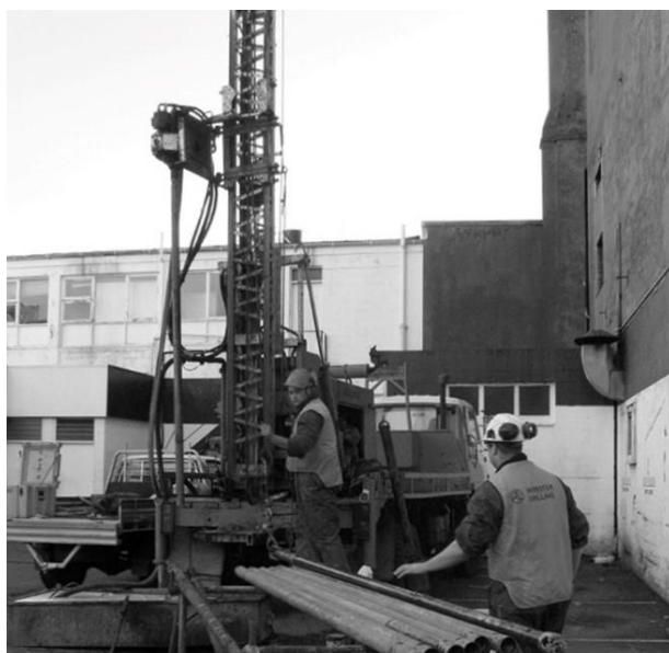
Gambar 3. Contoh peralatan pemboran untuk pengambilan sampel tanah yang akan diuji di laboratorium.
