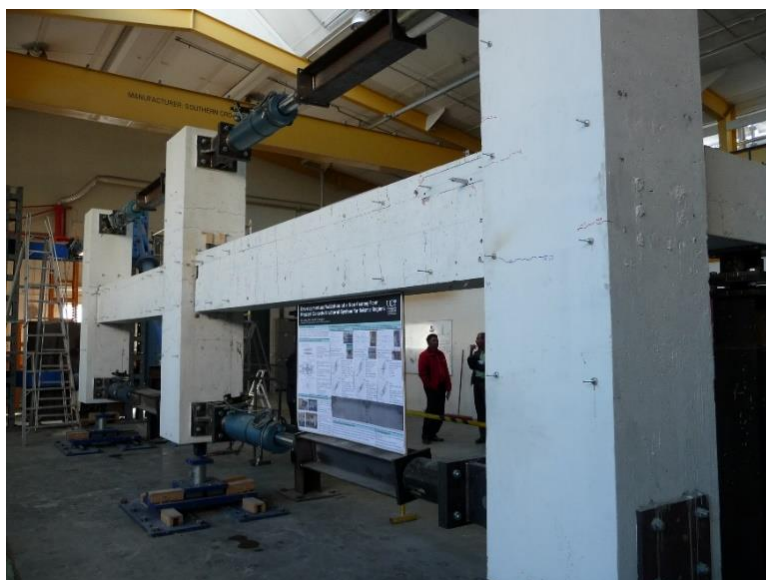
Gambar 1. Contoh penelitian dimana kolom dan balok beton bertulang skala penuh sedang diuji di laboratorium.
