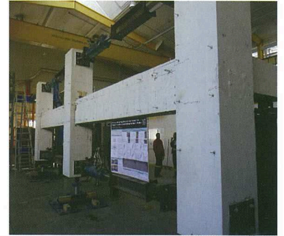
চিত্র ১. ফুল-স্কেল রেইনফোর্সড কংক্রিট কলাম এবং বিম একটি পরীক্ষাগারে পরীক্ষা করা হচ্ছে।
