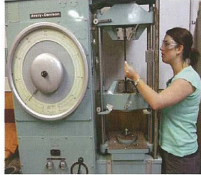
চিত্র ১. একটি রেইনফোর্সিং বার পরীক্ষা করা দেখা হচ্ছে যে এটিতে ন্যূনতম মানদণ্ড বজায় আছে কি না
